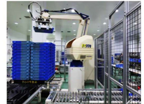
ロボットでクレートを集積
