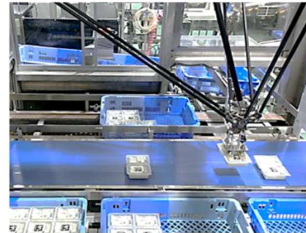
ロボットが豆腐を取り上げて箱詰め
